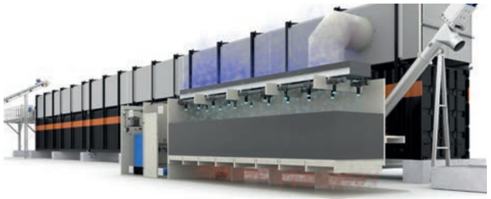
Blick auf den Abluftwäscher des CompoLiners inklusive Technikraum und Säurelager
