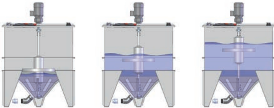
Schematische Darstellung der Funktionsweise des niveaugulierten Rührwerks
