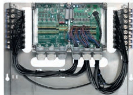
Ventilinsel zur pneumatischen Ansteuerung der Futterventile
