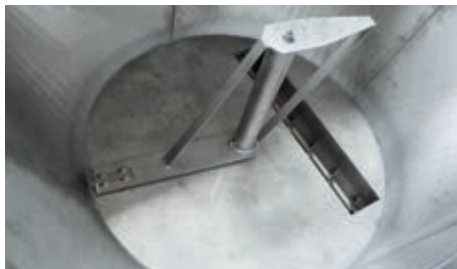
Behälterboden mit Z-Schwert und Austragsschnecke
