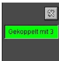
Slave mit Master 3 gekoppelt, wird angesteuert.
