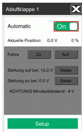
Bild 5-6: Analoge Abluftklappe mit Rückmeldung
