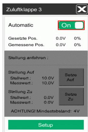
Bild 7-5: Analoge Zuluftklappen mit Rückmeldung
