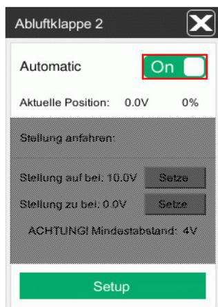
Bild 5-4: Analoge Abluftklappe ohne Rückmeldung
