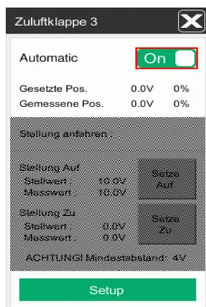
Bild 7-8: Analoge Zuluftklappen mit Rückmeldung
