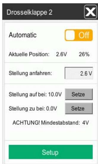
Bild 4-7: Analoge Drosselklappe
