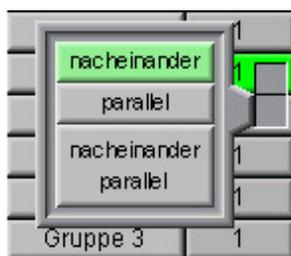
AMACS bietet die Möglichkeit bis zu drei stufenlose Ventilatoren anzusteuern. Wie hier zu sehen gibt es, wenn mehr als ein stufenloser Ventilator installiert ist, die Möglichkeit die Ventilatoren **nacheinander**, **parallel** oder **nacheinander parallel** zu schalten.
