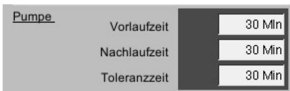
Damit beim Starten der Heizung nicht sofort das Gebläse startet und dadurch kalte Luft zu den Tieren gelangt, ist ein getrenntes Einschalten von Pumpe und Gebläse notwendig. Der Mischer regelt dabei analog die Heizleistung.
