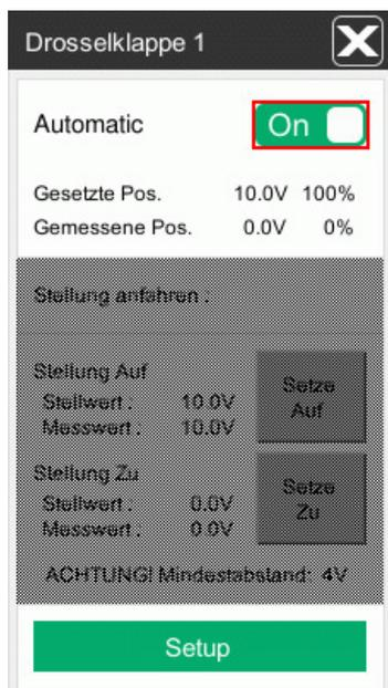
Bild 4-8: Analoge Klappe mit Rückmeldung
