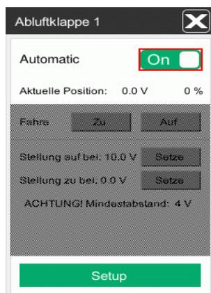
Bild 5-3: Relaisgesteuerte Abluftklappe
