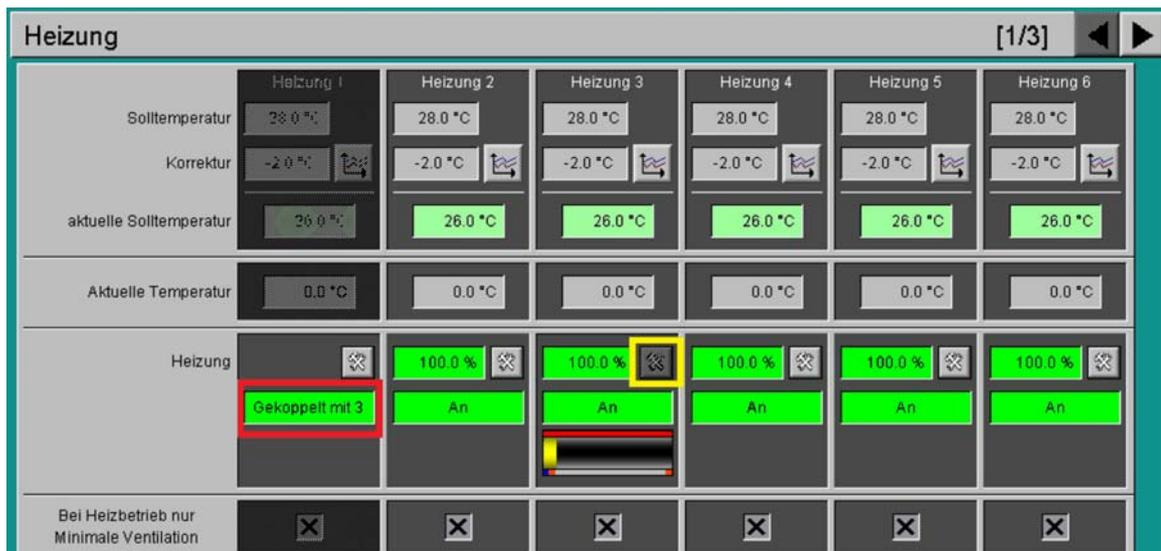
Bild 9-12: Heizungskoppelung aktiv
