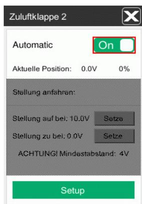
Bild 7-4: Analoge Zuluftklappen ohne Rückmeldung
