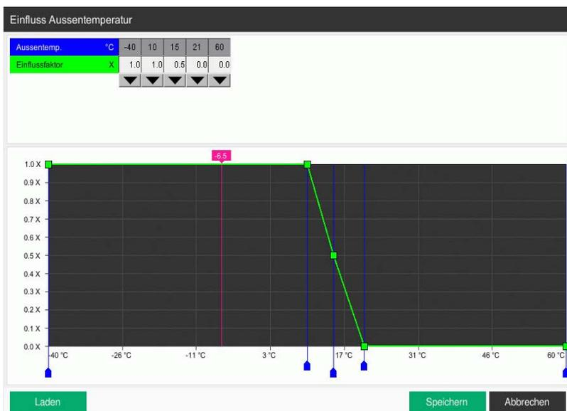
Bild 8-4: Einflussfaktor Außentemperatur
