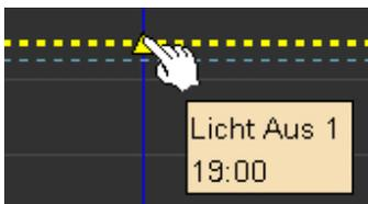
Durch Klicken auf die Dreiecke und Festhalten der Maus-taste, kann der Punkt in der Kurve vertikal auf die gewünschte Zeit verschoben werden. Wenn kurz mit der Maus auf der Schaltfläche gestoppt wird, wird die Funktion und die Startzeit des Stützpunktes angezeigt.
