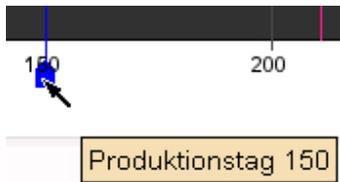
Durch Klicken auf die blaue Fahne und Festhalten der Maus-taste, kann der Punkt in der Kurve horizontal auf den gewünschten Tag verschoben werden. Wenn kurz mit der Maus auf der Schaltfläche gestoppt wird, wird der Produkti-onstag des Stützpunktes angezeigt.
