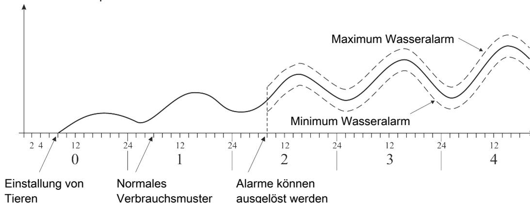
Abb. 13: Beispiel: Minimum und Maximum Wasseralarm
