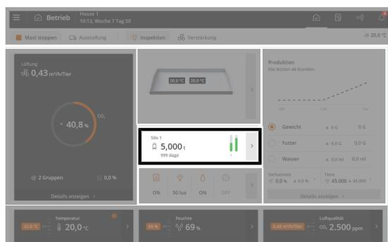
🏠 Betrieb. Die **Silo** Karte zeigt den Siloinhalt des aktiven Silos sowie eine Grafik für und die Anzahl der Tage, bis das Silo als leer berechnet wird.
