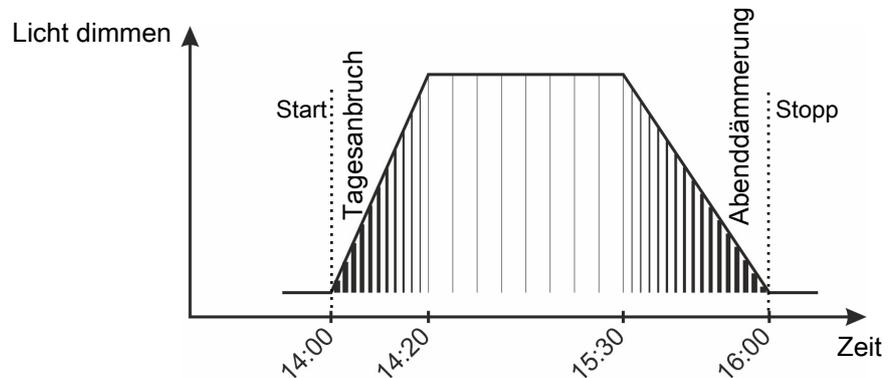
Abb. 10: Normale Lichtdimmung Morgengrauen und Abenddämmerung sind in den Lichtzeitraum integriert.
