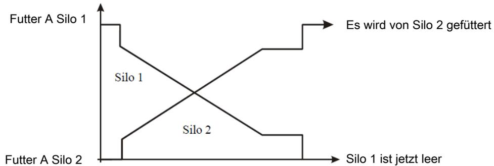
Abb. 11: Wenn der Inhalt im Silo eine vorgegebene Menge erreicht, beginnt der schrittweise Wechsel zu einem Silo mit der gleichen Art von Futter.
