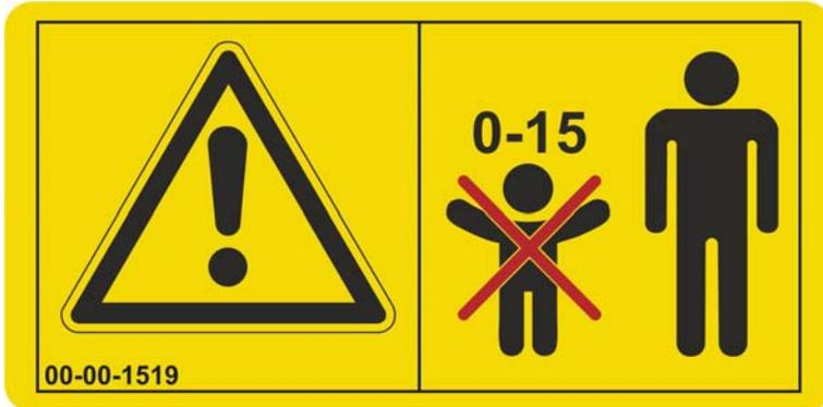
Ab dem 01.10.2016 muss dieses Piktogramm auf allen Modellen mit angetriebenen Einheiten oder Einheiten mit drehenden Teilen angebracht sein. Nur mit diesem Piktogramm darf ausgeliefert werden.
