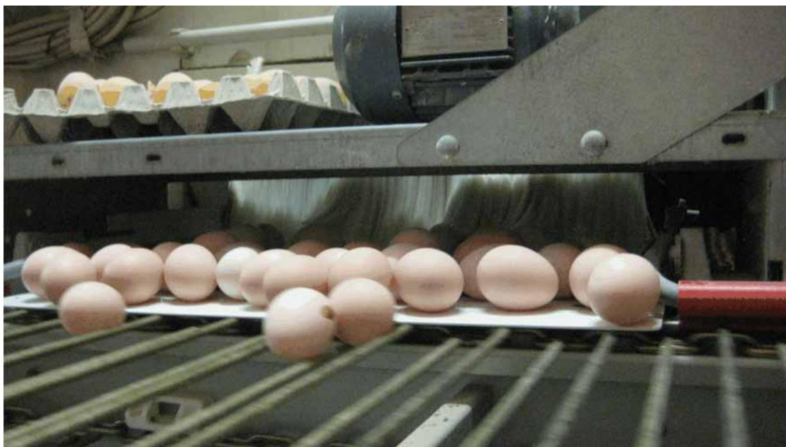
Rys. 5-3: Przekazywanie z gniazda na przenośnik poprzeczny
