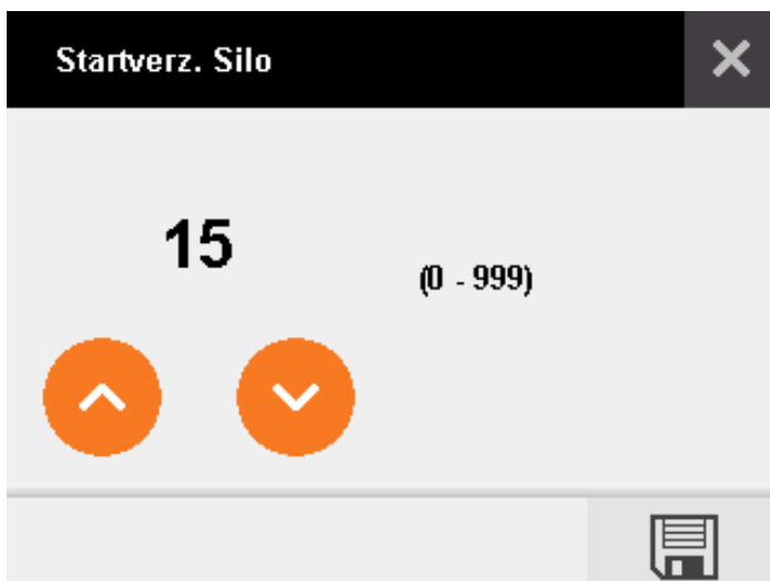
Bild 5-16: Startverzögerung des Silos
