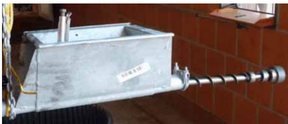
Bild 5-4: Spirale mit Gripzange fixieren
