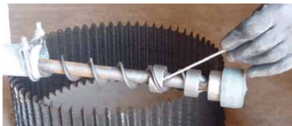
Bild 5-5: Spirale von Spannweile lösen
