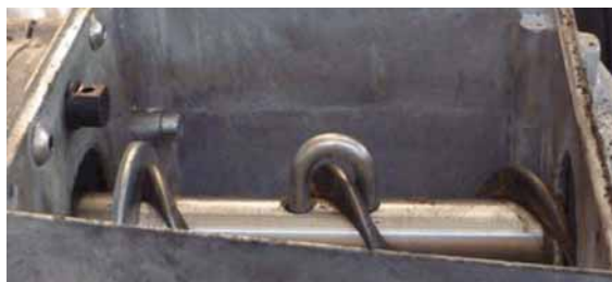
Bild 5-1: Spirale am Antrieb befestigen
