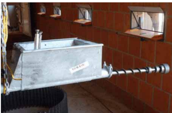
Bild 5-6: Spirale an Spannwellen
